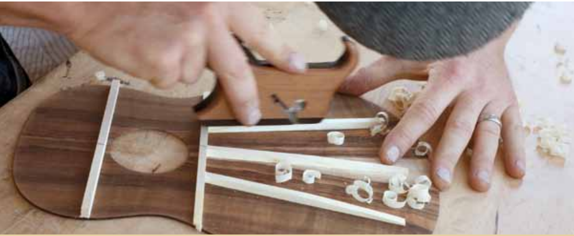
Andy Powers, muni d'un guillaume, réduit les barrages d'un ukulélé pour commencer l'ajustement de la sonorité de la table. "Je les travaille lentement, en allant de l'un à l'autre jusqu'à ce qu'ils soient proches de leur taille finale, tout en vérifiant le son de la table au fur et à mesure," nous explique-t-il. "J'ai fabriqué ce guillaume le jour de mon 13e anniversaire, et je l'ai utilisé sur quasiment toutes les guitares que j'ai réalisées depuis."
