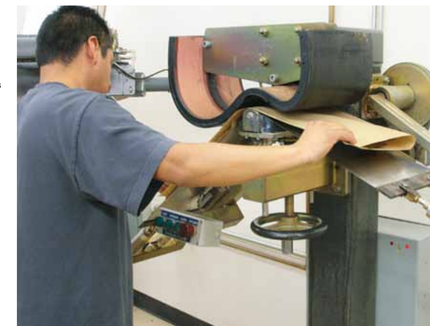
Page opposée : la découpe à commande numérique apporte précision et régularité au processus de façonnage des manches ; ci-dessus : les machines de cintrage des éclisses, conçues et fabriquées par le département outillage de Taylor, améliorent l'efficacité et réduisent les problèmes de casse
